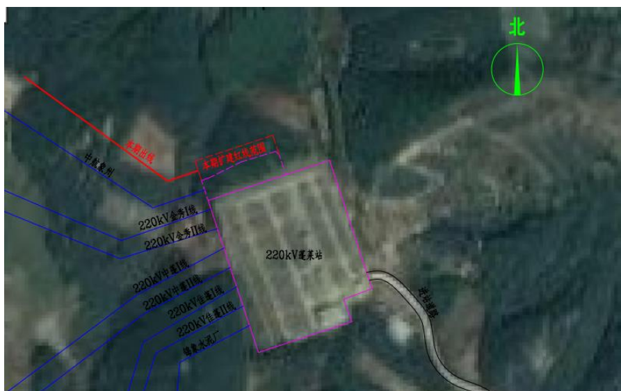
图 1.4-3 220kV 蓬莱站出线布置图
