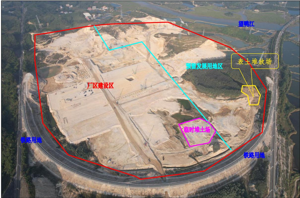
本季度中期现状图，主体正在进行场地开挖、回填，施工扰动区域主要为其他草地、坑塘水面、乔木林地，用地中坑塘水面区域为待建区，非基坑开挖造成的积水。本季度施工扰动均在永久征地范围内，施工虽造成一定水土流失，但未造成水土流失危害
