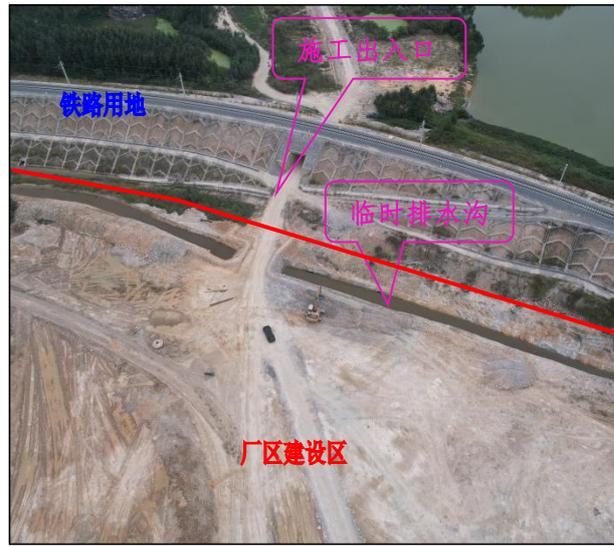
厂区建设区南面、临时堆土场现状图，施工采取泄洪渠沟槽排水的形式，监测将沟槽计列为临时排水沟，现状措施排水效果良好
