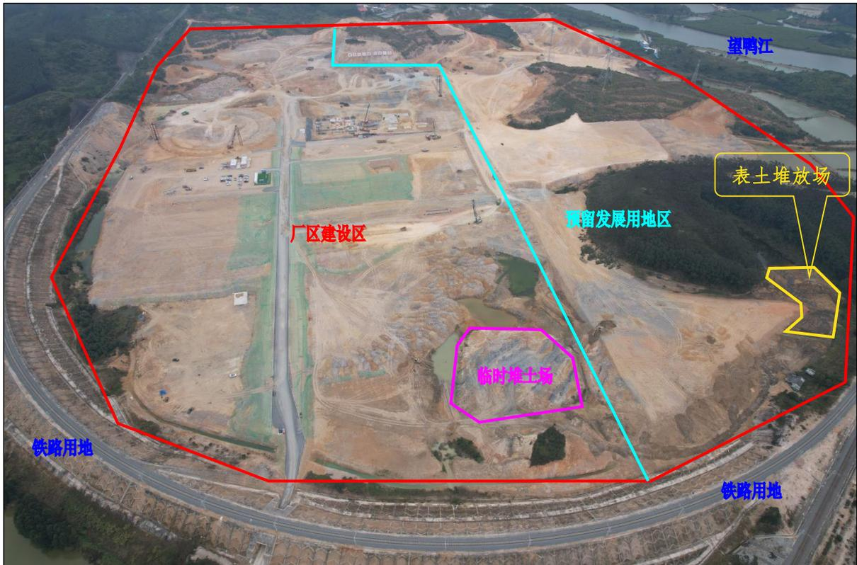
本季度末期建设现状图，厂区建设区主体已完成场地平整工作，正在进行构筑物基础建设，施工对临时运输道路两侧裸露地面进行临时苫盖密目网，本季度施工扰动均在永久征地范围内，施工虽造成一定水土流失，但未造成水土流失危害
