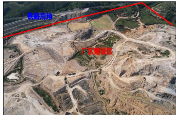
厂区建设区西南面、西面施工现状图，主体正在进行场地开挖、回填，场地临时排水采用截洪沟和坑塘排水沟渠排水形式，但施工未设置临时沉沙池，部分泥沙随雨水直接汇入截洪沟，造成一定水土流失，但现场无泥沙淤积堵塞排水沟的现象，未造成水土流失危害
