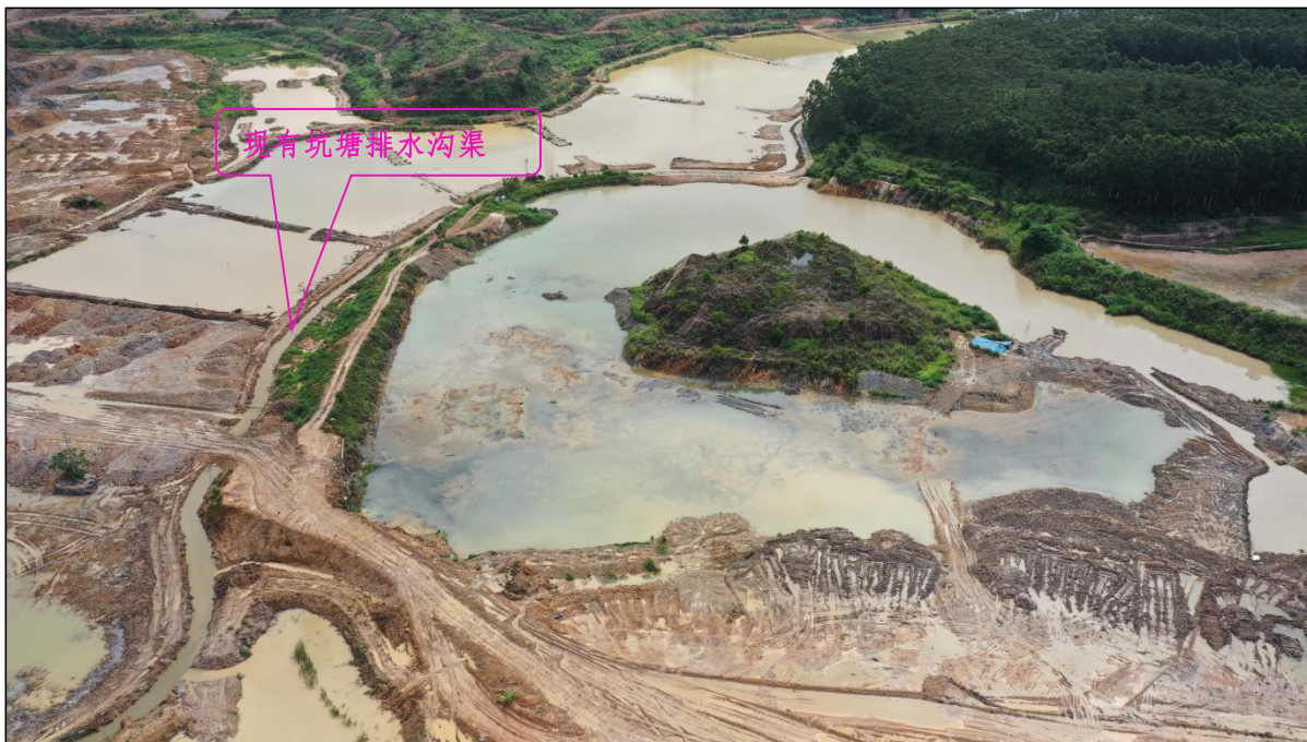
厂区建设区待建区用地中部现状图，未施工区域现状呈现为坑塘水面、乔木林地、其他草地，坑塘水面区域受到已施工区域排水的影响，现状造成轻度水土流失
