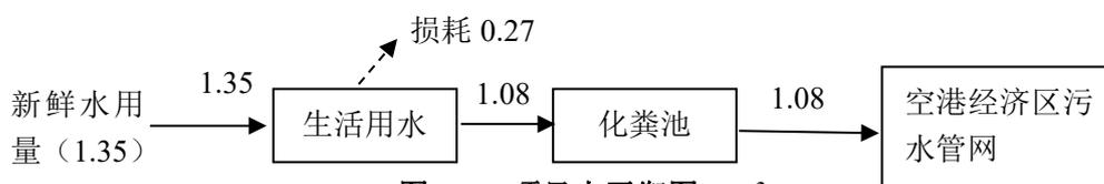
图 2-1 项目水平衡图 m<sup>3</sup>/d
