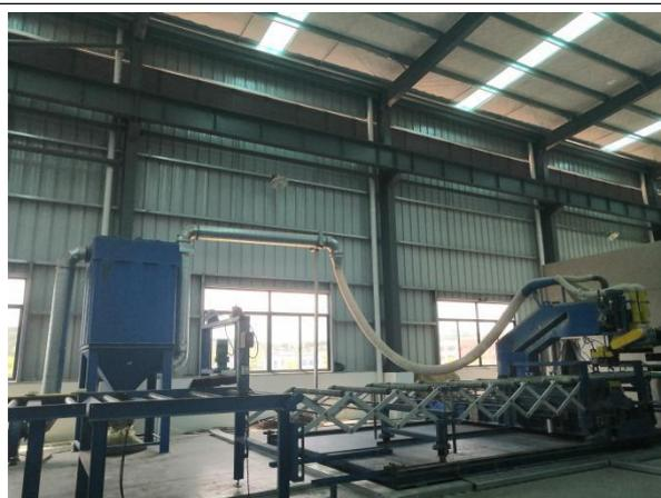
聚氨酯夹芯板切割工序除尘器
